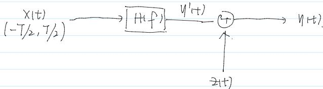
我们可以在噪声  $Z(t)$  看成一个双边功率密度为  $N_0$  的白噪声，经过带宽函数  $H(f)$  滤波后产生  $Z(t)$ 。由上面分析可知：
