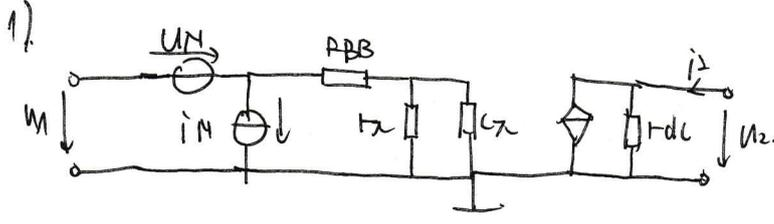
$$2) \begin{pmatrix} S_{UIN} & S_{IIN} \\ S_{IN} & S_{IN} \end{pmatrix} = \begin{pmatrix} G_{11} & G_{12} & G_{13} \\ G_{21} & G_{22} & G_{23} \end{pmatrix} \begin{pmatrix} S_{UNBB} & 0 & 0 \\ 0 & S_{INB} & 0 \\ 0 & 0 & S_{INC} \end{pmatrix} \begin{pmatrix} G_{11}^* & G_{21}^* \\ G_{12}^* & G_{22}^* \\ G_{13}^* & G_{23}^* \end{pmatrix}$$
